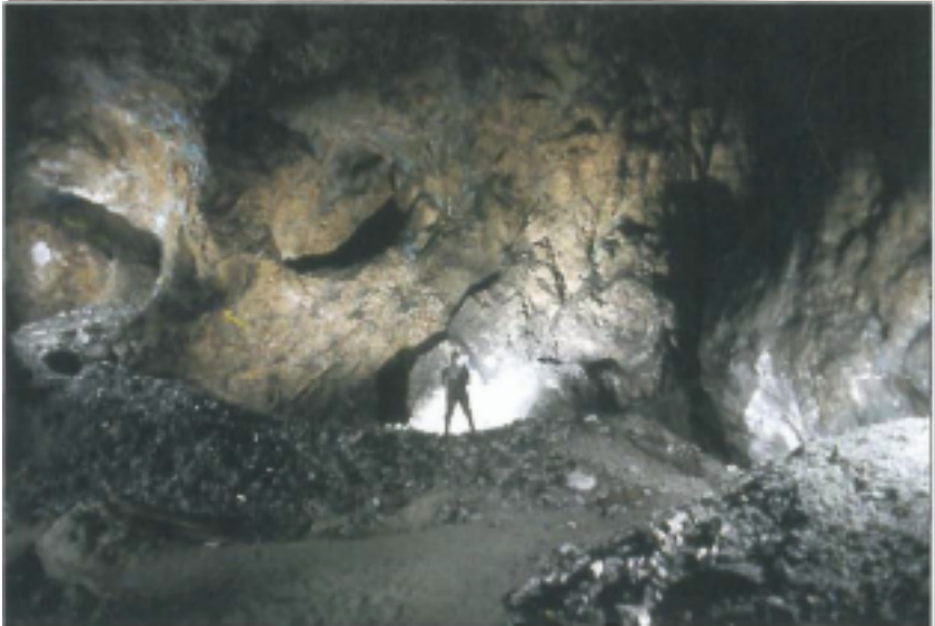
Abb. 3 Zeche, in der eine Breccienvererzung auf Fahlerze gebaut wurde. Unterwander Zeche im Tiefbau des Michaelstollens, Bergbau Großkogel bei Brixlegg. Primärer Abbau im frühen 16. Jahrhundert. Aufgrund des hohen Barytgehaltes — dieses Mineral war erst ab 1787 zunehmend von bergbaulichem Interesse — wurde durch den später erfolgten Barytabbau auch diese Zeche deutlich geweitet.
